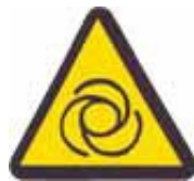
Warnung: Kompressor wird fernbedient und kann ohne Vorwarnung anlaufen
